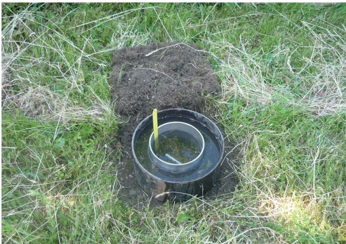
Obrázek č. 2: Prstencový infiltrometr
